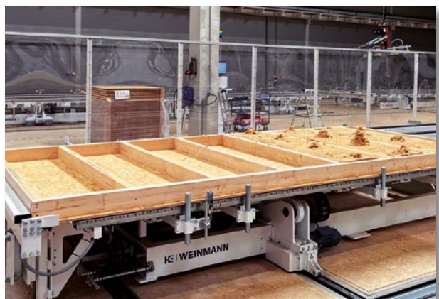
Vollautomatisches Einbringen von losen Dämmmaterialien
