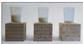
MDF 74 ml/dm<sup>3</sup>, Span 46 ml/dm<sup>3</sup>, SWL STAB 11 ml/dm<sup>3</sup>
