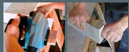
**Kantentechnik:** Platten können mit V-Nutfräse rückseitig eingekerbt werden, an der die Platte präzise von Hand gebogen wird. Es ergibt sich so eine geschlossene Außenkante.
