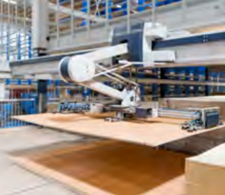
Das Grundner-Flächenlager in Funktion
