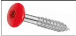
**Lagerware, lieferbar in allen vorrätigen Plattendekoren.** Zur Befestigung von Bekleidungsplatten auf Holz-Unterkonstruktionen. Beachten sie die Verarbeitungsanleitung und ggf. Zulassungen für das gewählte Bekleidungsmaterial. Zwängungsfreie Montage: sobald der Schraubkopf auf der Platte aufsitzt, den Einschraubvorgang beenden. Keinen zusätzlichen Drehmoment aufbringen. Allgemeine bauaufsichtliche Zulassung Z-33.9-428
