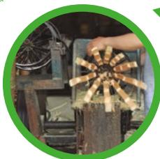
Verdichten der schmalen Bamboo X-treme® Streifen unter hohem Druck (Thermo-Density®).
