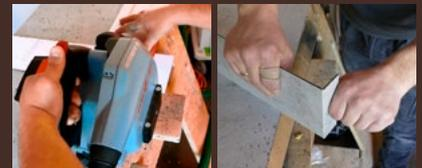
Kantentechnik: Platten können mit V-Nutfräse rückseitig eingekerbt werden, an der die Platte präzise von Hand gebogen werden kann. Es ergibt sich eine geschlossene Außenkante.
