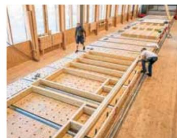
Die EGGER EcoBox in der Vorfertigung von Holzrahmenbauwänden und im Detail
