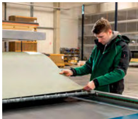
Das genaue Platzieren des Schichtstoffes auf die Trägerplatte ist wichtig, bevor es ans Verpressen geht und danach versendet oder eingelagert wird.
