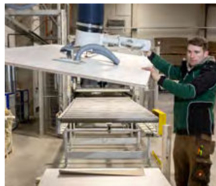
Das genaue Platzieren des Schichtstoffes auf die Trägerplatte ist wichtig, bevor es ans Verpressen geht und danach versendet oder eingelagert wird.
