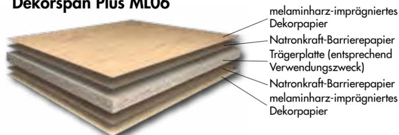
Mehrblattaufbau (Nennstärke plus beidseitig 0,3 mm)
