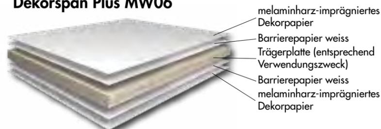
Mehrfachlagenaufbau (Nennstärke plus beidseitig 0,6 mm)
